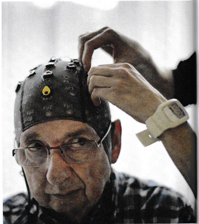
Una fisioterapeuta coloca unos electrodos en la cabeza a un paciente suizo con una grave discapacidad motora. Se trata de parte de un prototipo de interfaz cerebro-máquina que podría mejorar los movimientos del paciente.
